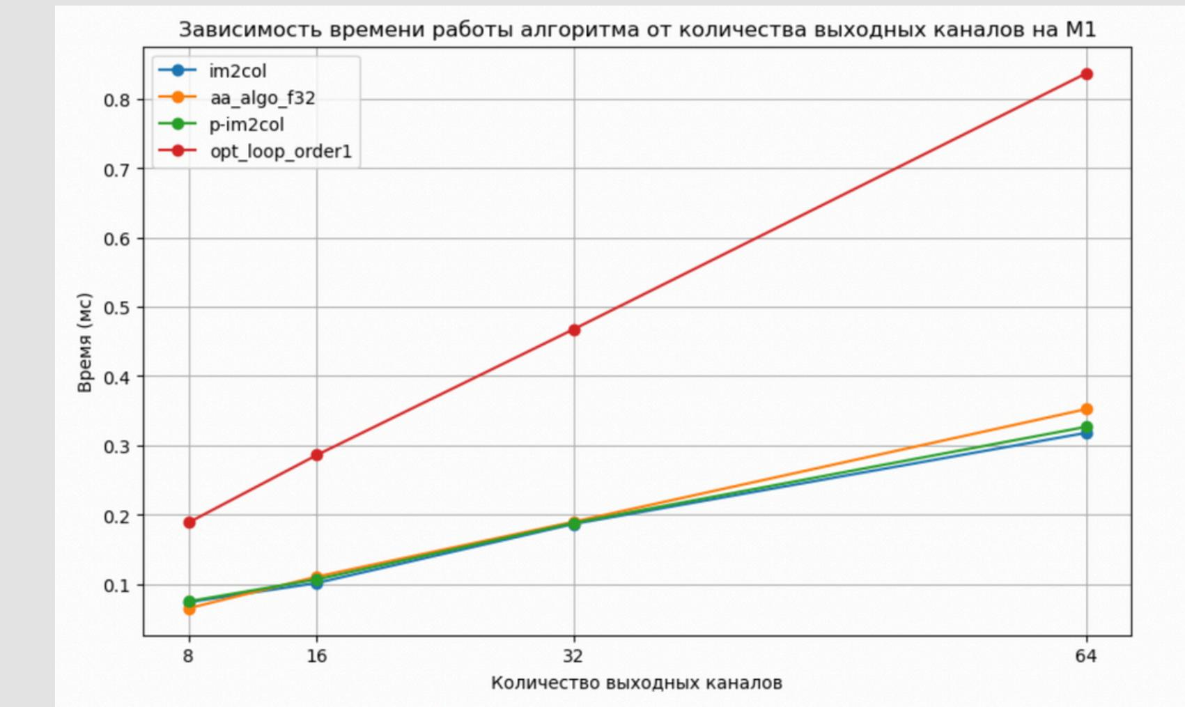
`opt_loop_order` - наилучшая версия прямой свертки с использованием simd и tiling
